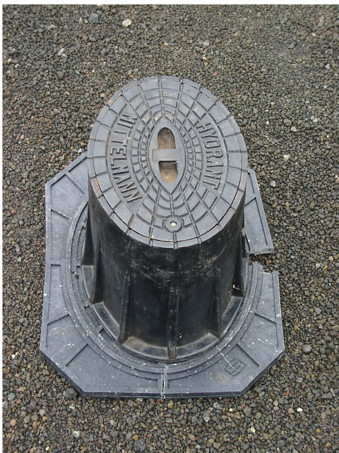
Abbildung 1: Tragplatte Typ 3, 420 x 530 mm mit Straßenkappe DIN 4055 nach Prüfung der Bruchlast.
